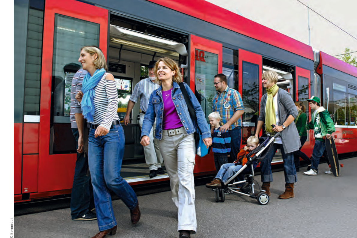
Viele und breite Türen: Moderne Trams wie hier in Bern ermöglichen ein effizientes Ein- und Aussteigen.
